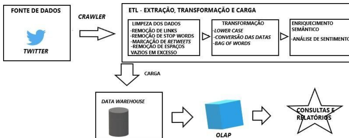
Figura 1. Arquitetura utilizada para coleta e Data Warehousing
